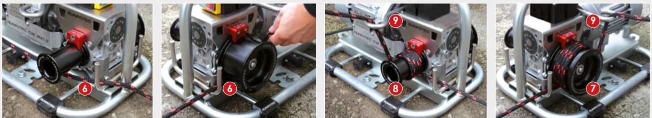
Die bedienende Person steht neben der Spillwinde mit ausreichendem Sicherheitsabstand und zieht mit geringem Kraftaufwand im 90° Winkel zur Zugrichtung am Zugseil. Der Kraftaufwand sollte nur so stark sein, bis die Vorschubgeschwindigkeit erreicht ist. Sehr kräftiges Ziehen erhöht die Zugkraft der Spillwinde nicht!
