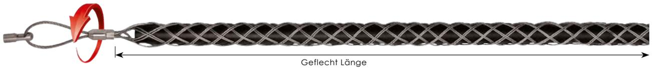
Für **Kabeldurchmesser Ø 9 – 31 mm**. Kompatibel mit GF3 / GF4.5 / GF6 / GF7.5 / GF9 / GF11 Glasfaserstäbe und RUNPOSTICKS. Gefertigt aus flexiblem Edelstahl Drahtgeflecht. Hochwertige Materialien mit langer Lebensdauer! Vorteile Drallausgleich: Kabel kann sich im Rohr drehen, verhindert ungewolltes Abschrauben vom Gewinde.
