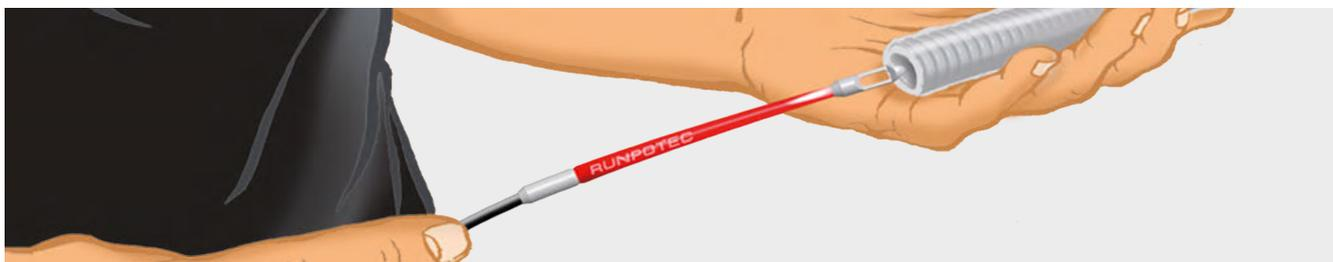
**RP 1**, Spezialkunststoffband Ø 4 mm. Spiralspitze: 1 x RG6 - Führungsspitze mit Spezialösenkopf. Extrem gutes Biege und Gleitverhalten, großes Ösenloch bis zu 7 x 2,5 mm<sup>2</sup> Kabelaufnahme, perfekte Verarbeitung, keine Stoßkanten und hohe Zuglast. Spiralende: mit schraubbarer Zugöse mit Gewinde RTG Ø 6 mm. Optimales Einsatzgebiet: Rohr - Ø 16, 25 und 32 mm
