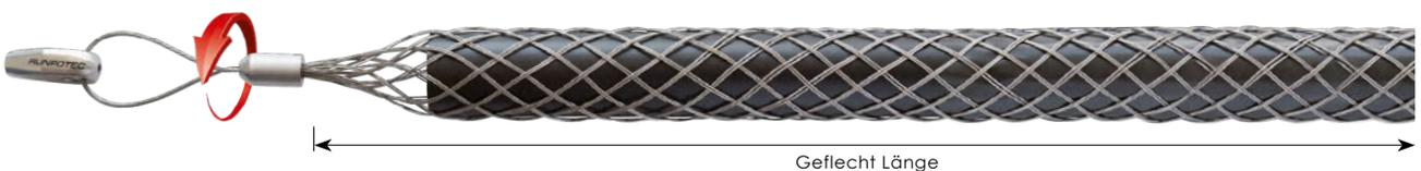
Für **Kabeldurchmesser Ø 30 – 100 mm**. Vorzugsweise in Kombination mit allen Glasfaserstäben sowie RUNPOTEC Produkten mit Gewinde RTG Ø 12 mm. Gefertigt aus flexiblem Edelstahl Drahtgeflecht. Vorteile Drallausgleich: Kabel kann sich im Rohr drehen, verhindert ungewolltes Abschrauben vom Gewinde.
