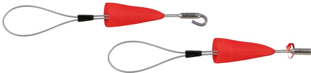
**Kabelziehschlaufe** mit Haken oder Gewinde RTG Ø 6 mm, mit Schutzkappe und flexibler Schlaufe aus Edelstahl mit Ø 1,5 mm. Optimales Einsatzgebiet: Um konfektionierte Kabel inkl. Stecker geschützt zu ziehen. Für Rohre ab 14 mm Innendurchmesser und nicht geführte Leitungen.
