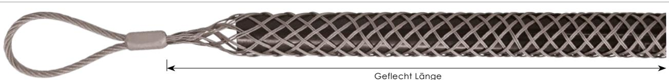
Für **Kabeldurchmesser Ø 10 – 100 mm**. Vorzugsweise in Kombination mit der CW 800 E Spillwinde. Gefertigt aus hochwertigem, flexiblem und verzinktem Doppel-Stahldrahtgeflecht. Bei permanentem Zug wird empfohlen in Kombination mit dem Verbindungswirbel mit Drallausgleich (siehe Zubehör Art.Nr. 10176) zu arbeiten.
