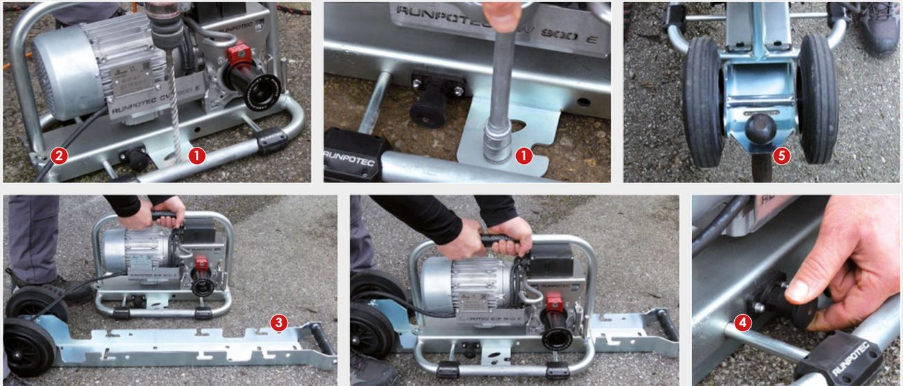
Anwendung der CW 800 E Spillwinde:
