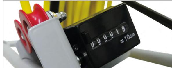
**MECHANISCHES ZÄHLWERK** mit gehärtetem Räderad.
