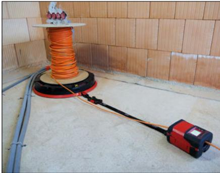
RUNPOMETER RM35 mit **Gurt und Clip-System** an XB 500 befestigt
