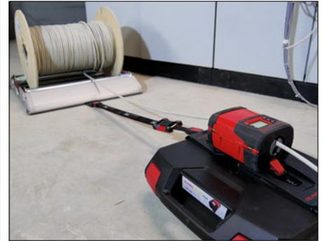
RUNPOMETER RM35 mit **Ankerpad und Gurt** an Kabeltrommelabroller befestigt
