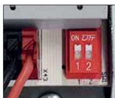
Dip switch per la selezione della corrente in uscita
