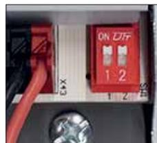
Dip switch per la selezione della corrente in uscita
