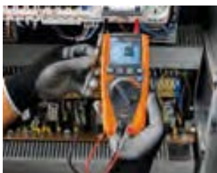
LoZ Funktion eliminiert Streuspannungen
