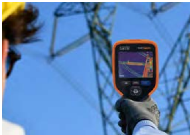
Hochspannungsisolator aufgenommen mit der THT600L
