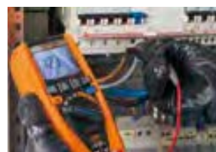
Drehfeldrichtung mit 1-phasiger Methode.
