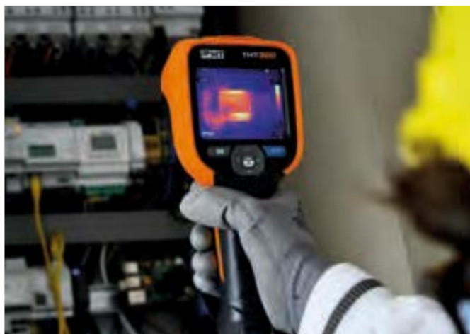
Ein überhitzer Lüftermotor aufgenommen mit der THT300
