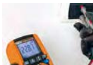
LoZ Funktion eliminiert Streuspannungen.
