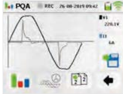
Netzanalyse Scopefunktion Spannung und Strom
