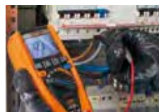
Drehfeldrichtung mit 1-phasiger Methode.
