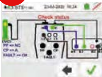
Anschlusschema für Status A im Prüfablauf EVSE
