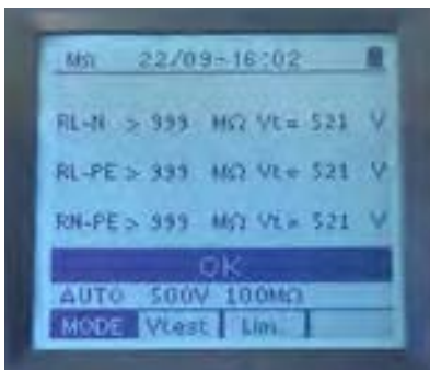
Isolationsmessung gegen alle Leiter L-N-PE
