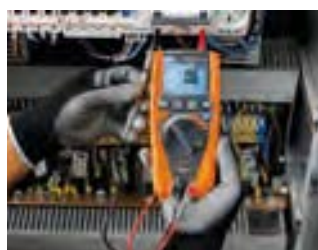
LoZ Funktion eliminiert Streuspannungen
