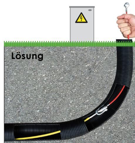
Ø 7,5 - 9 oder 11 mm Glasfaserstab stoppt bei zu engem Rohr-Radius.
