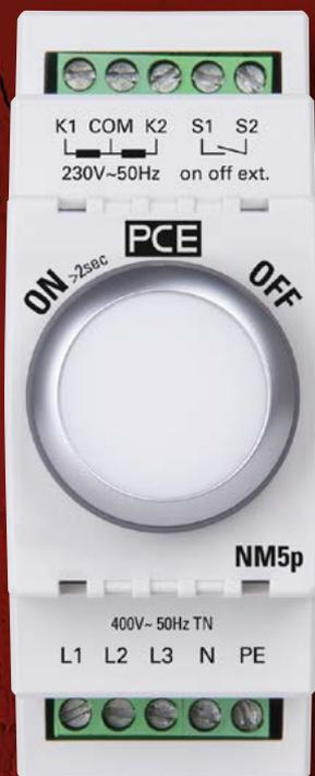
Das mikroprozessorgesteuerte Netzmonitorgerät NM5p dient zur Überwachung von Phasen-, Neutral- sowie Schutzleiter 5-poliger 400V Steckvorrichtung in TT & TN-Stromversorgungsnetzen.
