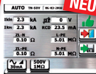
AUTO-Sequenz (autom. Prüfablauf) Ergebnisanzeige
