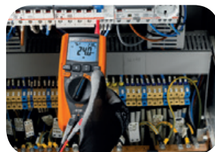
RCD Auslösezeit t_a und Auslösestrom I_a
