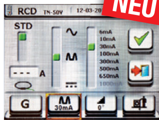
RCD Messung Auswahl RCD Typ A, AC, B oder EV
