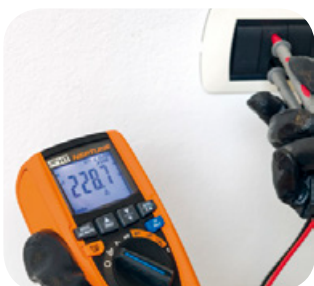
LoZ Funktion eliminiert Streuspannungen.
