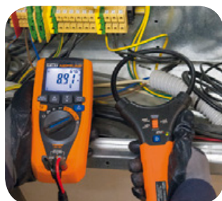
Messung des Stroms mit flexiblem Wandler.
