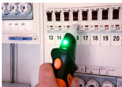
Grüne LED: Sicherung gehört zum gesuchten Stromkreis.
