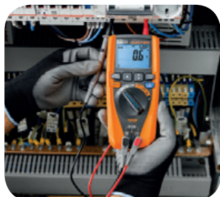
LoZ Funktion eliminiert Streuspannungen.
