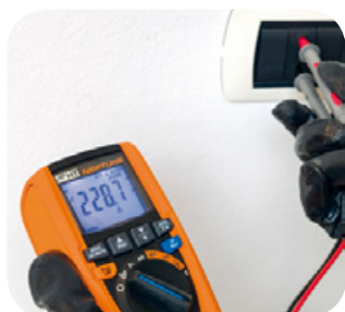
LoZ Funktion eliminiert Streuspannungen.
