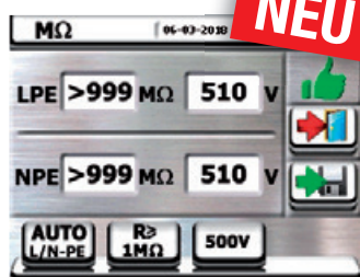
AUTO Isolationsmessung mit L/N und L/PE Ergebnisanzeige
