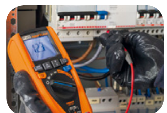
Drehfeldrichtung mit 1-phasiger Methode.
