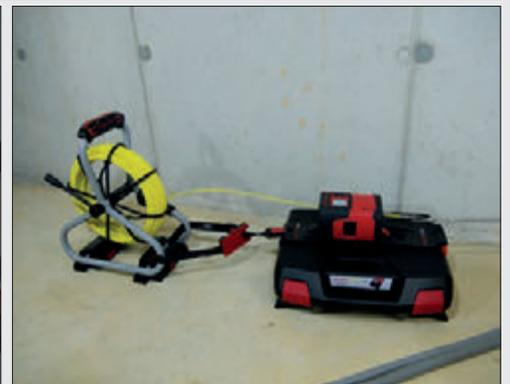
RM35 mit Montageplatte-Systemkoffer, Glasfasereinziehsystem Ø 4,5 mm
