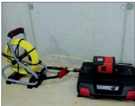
RM35 mit Montageplatte-Systemkoffer, Glasfasereinziehsystem Ø 4,5 mm
