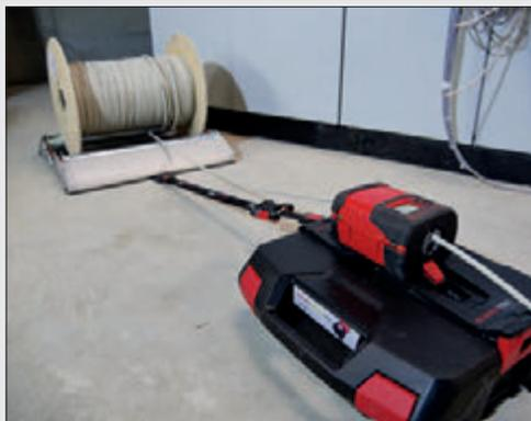
RUNPOMETER RM35 mit Ankerpad und Gurt an Kabeltrommelabroller befestigt
