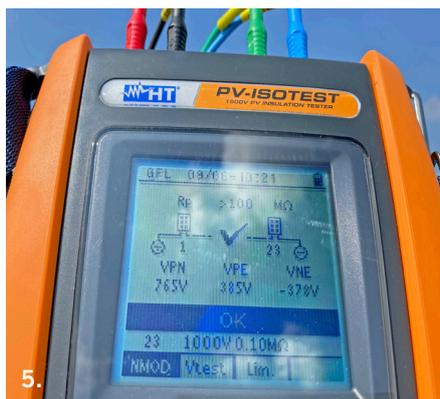
5. Nach erfolgter Reparatur haben wir das **PV-ISOTEST** erneut angeschlossen und im Messergebnis den korrekten Zustand ermittelt.
