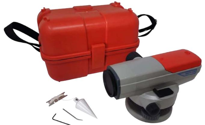
Aufbewahrung und Transport in einem stabilen Tragekoffer, der ein Senklot zur einfachen Positionierung enthält
