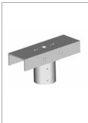
Code: 703952.NEW Euro: 75,00 Fixation de poteau pour 1 ou 2 projecteurs Ø 60/76 mm en fer peint avec des poudres thermo-durcissables. Polyesters résistants à la corrosion et aux agents atmosphériques. Mastbefestigung für 1 oder 2 Scheinwerfer, Ø 60/76 mm. Aus mit duroplastischem Polyester-Pulver lackiertem Eisen; wetter- und korrosionsbeständig.
