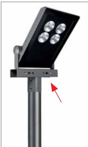
Code: 703952.NEW Euro: 75,00 Fixation de poteau pour 1 ou 2 projecteurs Ø 60/76 mm en fer peint avec des poudres thermo-durcissables. Polyesters résistants à la corrosion et aux agents atmosphériques. Mastbefestigung für 1 oder 2 Scheinwerfer, Ø 60/76 mm. Aus mit duroplastischem Polyester-Pulver lackiertem Eisen; wetter- und korrosionsbeständig.
